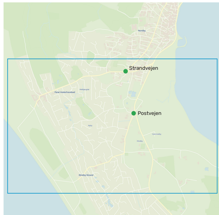
Figur 13: Oversigt over området omkring Rindby Strand. Lokationerne for maskinelle trafiktællinger er markeret med grøn prik. Den blå firkant markerer udsnittet for udtrækket fra Connected Cars i området.
